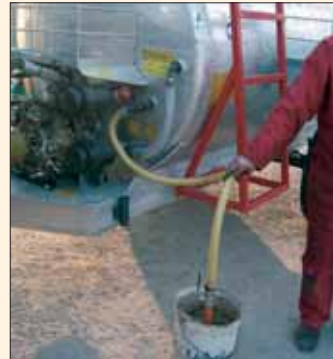
Sonda Aspiratrice F2. Sonde-Aspirateur F2 Dissolveur de pesticides en poudre.
